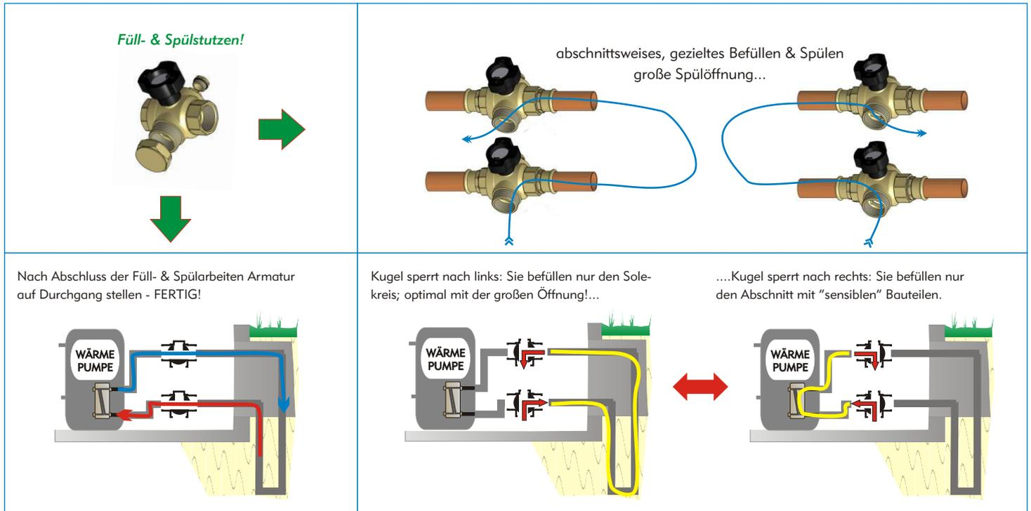
Lösung für 1 1/2" und 2" **Füll-& Spüleinheit DN40 und DN50**
