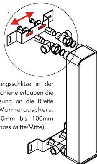
Die Längsschlitze in der Wandschiene erlauben die Anpassung an die Breite des Wärmetauschers. Von 40mm bis 100mm (Lochmass Mitte/Mitte).
