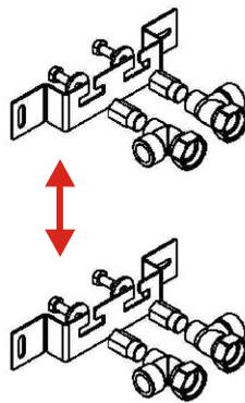
Egal wie lang der Wärmetauscher ist, unser Produkt passt. Die zwei Wandschienen liefern dazu die nötige Flexibilität, um unterschiedlich lange Wärmetauscher aufzunehmen.
