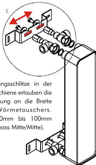
Die Längsschlitz in der Wandschiene erlauben die Anpassung an die Breite des Wärmetauschers. Von 40mm bis 100mm (Lochmass Mitte/Mitte).
