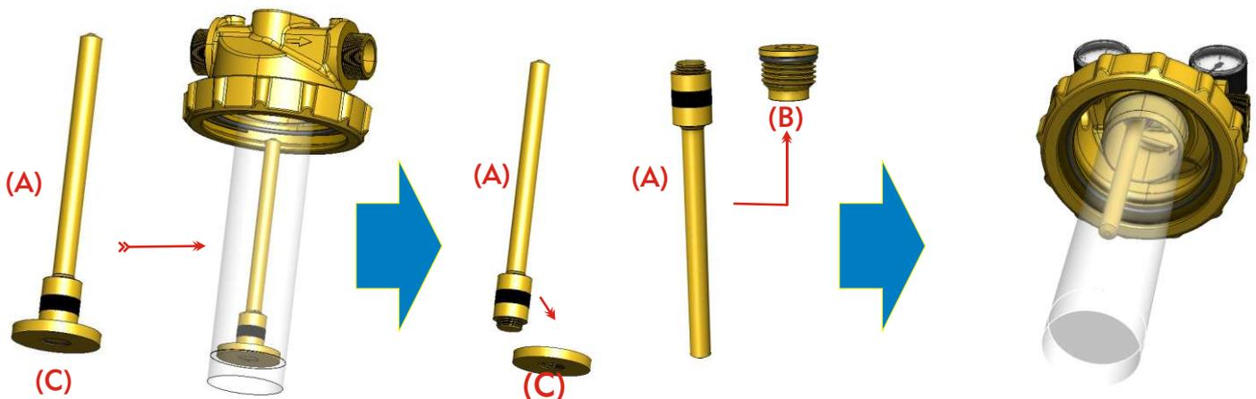
Die bisherige Version der Magnetkerze wurde auf den Boden des Filtersiebes gestellt. Das behalten wir für die Übergangszeit bei. Die aktuelle Magnetkerze (A) wird in einer Scheibe (C) montiert geliefert. Somit entspricht diese von Aufbau, Platzierung, Wirkung & Wartung der ursprünglichen. Magnet-Kerze.
