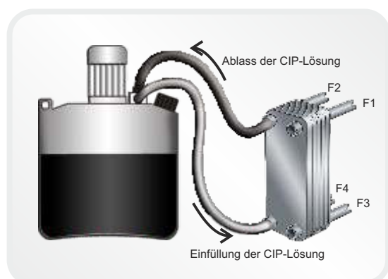
Gelötete Wärmetauscher können mit zusätzlichen CIP-Anschlüssen auf der Rückseite ausgestattet werden, um die Reinigung zu erleichtern, falls diese häufiger durchgeführt wird.
