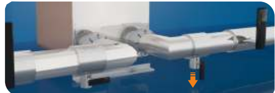
Stoppen Sie die CIP-Maschine. Lassen Sie die Reinigungsflüssigkeit aus dem Wärmetauscher und der CIP-Maschine ab.
