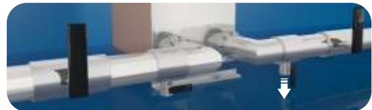
Entleeren Sie den gelöteten Plattenwärmetauscher.
