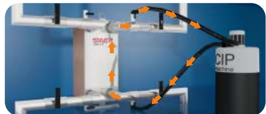
Schließen Sie die CIP-Maschine über den Ein- und Auslass an der Vorder- oder Rückseite an. Pumpen Sie die Lösung über den unteren Anschlusspunkt in den Wärmetauscher, um ein Ausströmen von Luft zu ermöglichen. Kehren Sie den Fluss alle 30 Minuten um.
